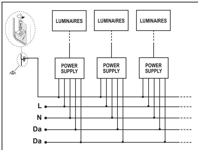
IT Cablare alla rete elettrica il power supply solo dopo aver effettuato il collegamento ai prodotti
