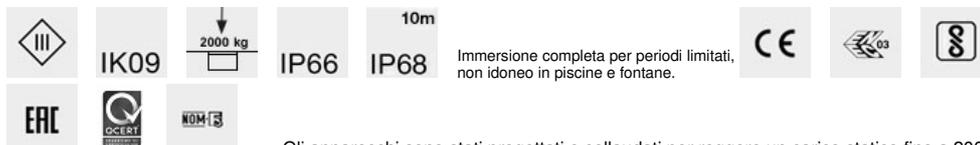
□ Gli apparecchi sono stati progettati e collaudati per reggere un carico statico fino a 20000 N e sono carrabili per autoveicoli con pneumatici. Gli apparecchi non possono essere impiegati in corsie nelle quali sono sottoposti a sollecitazioni orizzontali dovute a accelerazioni, frenate e/o cambi di direzione.
