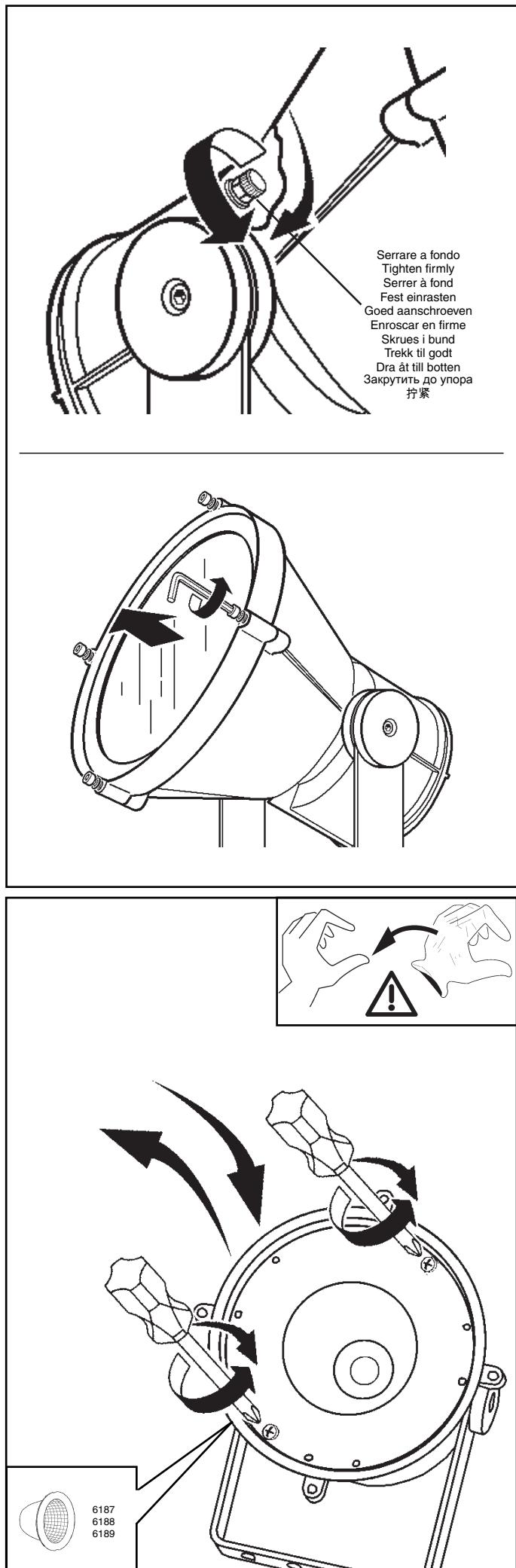
I Le molle di sostegno per i filtri hanno due sedi ad altezze differenti. Questo permette di installare contemporaneamente filtri colorati e diffusori.
