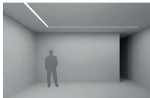
③ iN 60 Minimal: composición lineal "Overlapping" L=8,6m con módulo raíl
