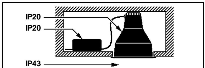
I Installando il prodotto a plafone in un vano chiuso, il grado di protezione è quello indicato in figura.
