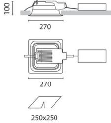
mit **metallisierte Spiegeloptik und Elektronisches Vorschaltgerät- 2 x 26W/32W/42W TC-DEL/TC-TEL**
