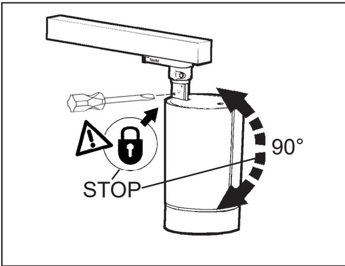
REGOLAZIONE DELL'INTENSITA' LUMINOSA - ADJUSTING THE LUMINOSITY - RÉGLAGE DE L'INTENSITÉ LUMINEUSE - EINSTELLEN DER LICHTSTÄRKE - HET REGELEN VAN DE LICHTSTERKTE - REGULACION DE LA INTENSIDAD LUMINOSA - JUSTERING AF LYSSTYRKEN - JUSTERE LYSSTYRKEN - INSTÄLLNING AV LJUSSTYRKA - НАСТРОЙКА ИНТЕНСИВНОСТИ ОСВЕЩЕНИЯ - 調整亮度 - تعديل شدة الضوء
