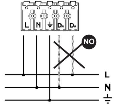
**IT** ATTENZIONE: con questo errore di collegamento il prodotto rischia di bloccarsi (FIG. 1). Per ripristinare, premere il pulsante 5 volte in 3 secondi come in FIG. 2, dopo che il difetto è stato rimosso.
