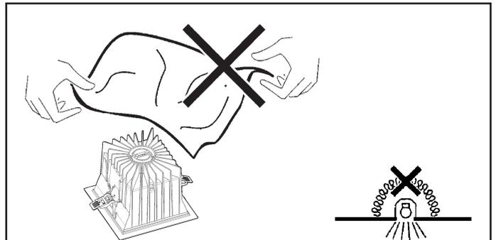
IT N.B.: Apparecchi non idonei ad essere coperti di materiale termicamente isolante
