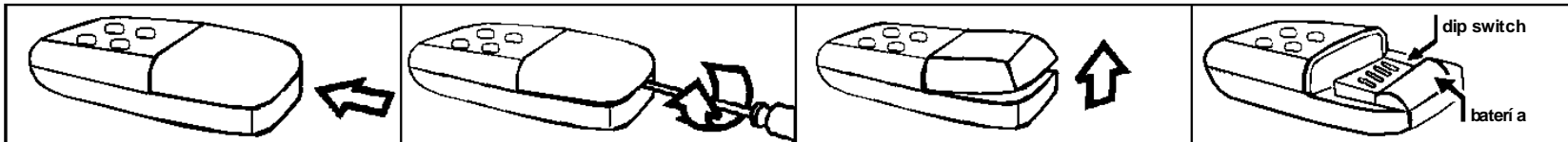
Apertura del radiomando para sustitución baterías y programación código
