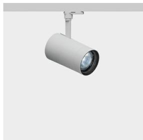
**Référence produit**MJ88: Projecteur corps moyen - 21W - LED 1600 lm - blanc chaud - CRI (Ra) 90 - transformateur gradateur électronique - optique spot **Attention ! Code abandonné****Description technique**
